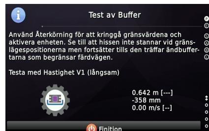
Vid test av avstånd till buffert och meddrivning kör hiss till ett ändplan och ställ återkörningsdonet i läge "Servicekörning"
